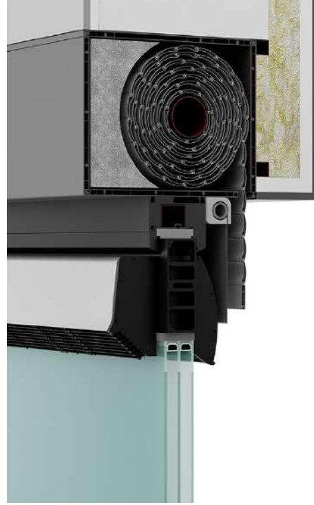
Dođrama İçi Yatay Sercair - Monoblok Panjur Montajı Detayı - Perspektif
